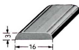
Baguette bombée largeur 16mm
