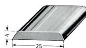
Baguette bombée largeur 25mm
