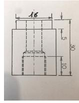
Bague à souder sur le réservoir
