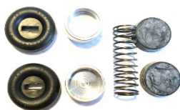
Kit complet réparation cylindre de roue avant 1" 1/8 Réf 120632
