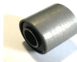
Silentbloc côté châssis
