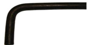
Durite de chauffage à culasse avant mars 1958
