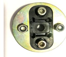
Flector de direction avec vis et écrous
