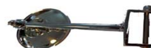
Rétroviseur gauche ou droit à fixer sur charnière de porte acier inoxydable
