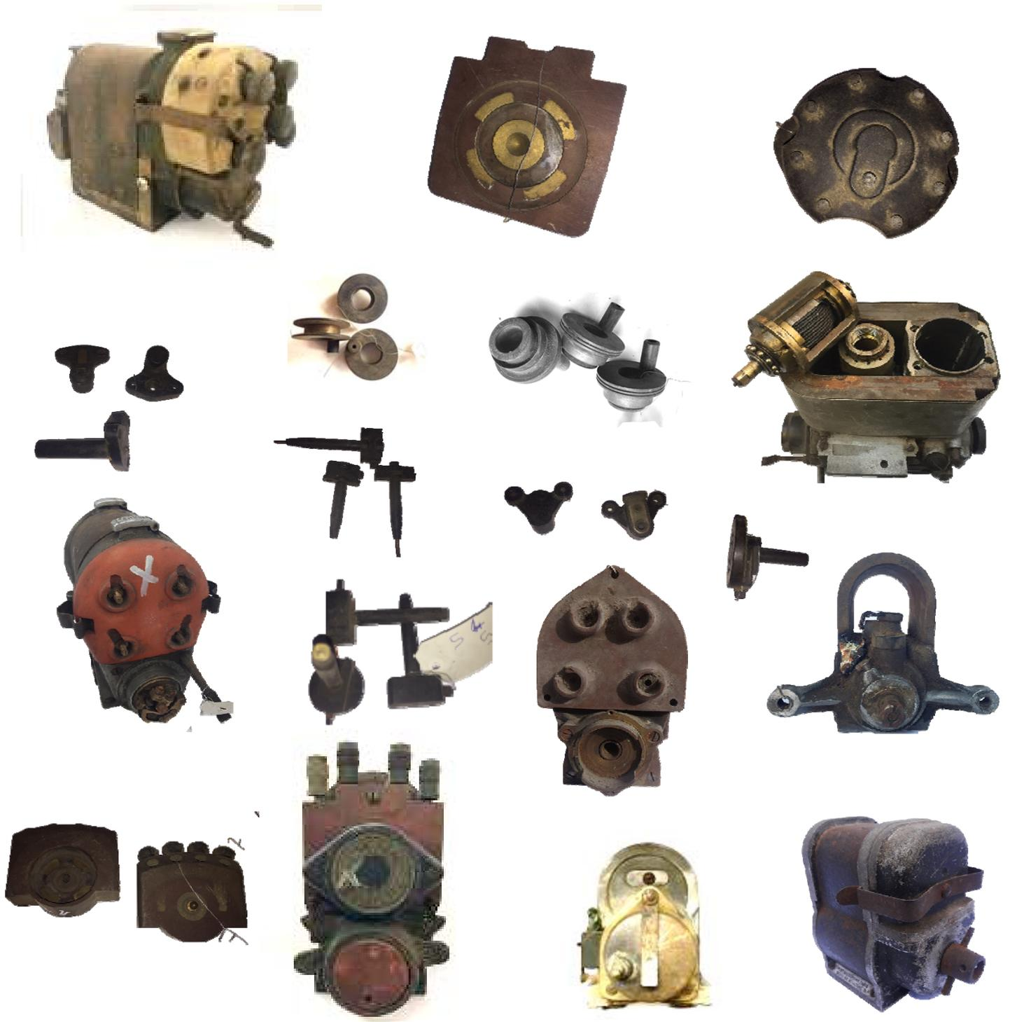
Condensateurs, rupteurs, charbons rotatifs, charbons collecteur, bagues collectrices, couvercles de rupteurs, accouplements à flector, etc...
