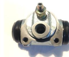
Cylindre de roue AR pistons creux
