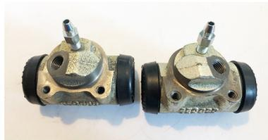
Paire de cylindres de roue AV pistons creux
