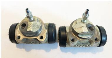
Paire de cylindres de roue AV pistons standards
