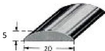
Baguette bombée largeur 20mm
