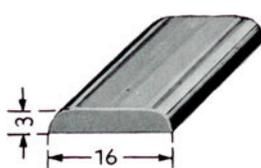
Baguette bombée largeur 16mm
