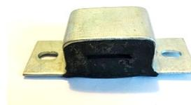
Silentbloc du ressort de réaction
