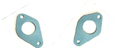
Joint entre tubulure et bloc
